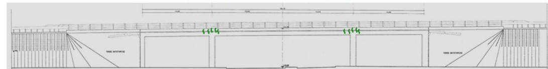
Σχήμα 4. Σχηματική απεικόνιση πιθανών εγκάρσιων ρηγματώσεων στην άνω παρειά και εγκάρσιων ρηγματώσεων στην πλαϊνή παρειά
